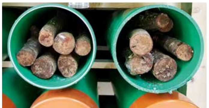
Ausgeklügelt: Schlüpfallen-Anlage der BFH-HAFL für neu geschaffenes Totholz. Ingénieux: pièges à émergence contenant le bois mort créé artificiellement.
