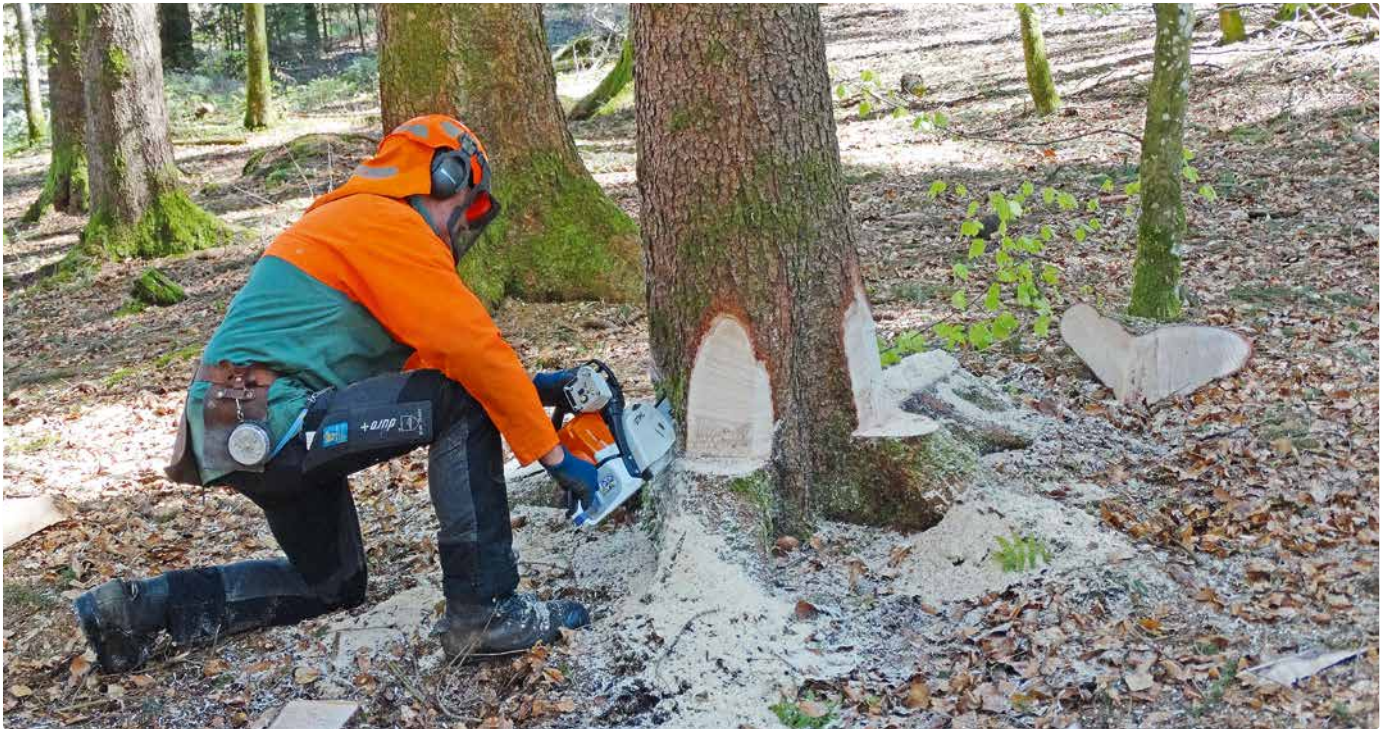
Die Sensoren zeichnen jede Bewegung auf: Der Forstwart schneidet die Fallkerbe. | Les capteurs enregistrent chaque mouvement: le bûcheron coupe les entailles.
